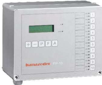
Die frei programmierbare, universell einsetzbare Solar- und Heizungssteuerung ist trotz des großen Funktionsumfangs übersichtlich und einfach zu bedienen. Mit LED-Statusanzeige und Taste für Modus Auto-Ein-Aus für jeden Ausgang; mehrzeiliges Display mit Klartextanzeige und abschaltbarer Hintergrundbeleuchtung; komfortable Programmierung über PC oder auch per Tasteneingabe direkt am Gerät möglich;
