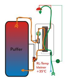
"Duschwasser" (grün), strömt durch den Tauscher zum Abnehmer. Die Pufferpumpe fördert heißes Pufferwassser (orange) im Gegenstrom durch den Wärmetauscher. Die tiefen Pufferrücklauftemperaturen werden in den unteren Bereich des Puffers geleitet.
