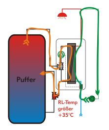
"Zirkulationswasser" (grün), strömt durch den Tauscher zur Nacherwärmung. Die Pufferpumpe fördert heißes Pufferwassser (orange) im Gegenstrom durch den Wärmetauscher Die hohen Pufferrücklauftemperaturen werden von "OptiZirk" in den oberen Bereich des Puffers, in die warme Zone gelenkt.
