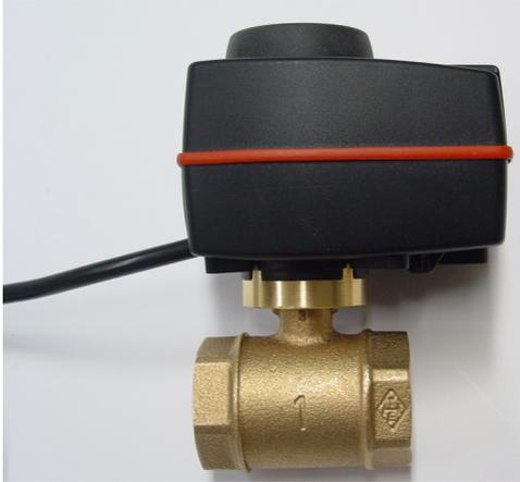
Nun bietet die Fa. Solar-Partner Süd GmbH einen elektromotorischen Antrieb für die GLOBO-Kugelhähne an. Der ESBE-Stellantrieb Typ ARA645 mit einer Stellzeit von 30 Sekunden verfügt über ein Drehmoment von 6 Nm.
