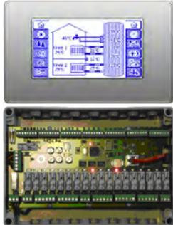
Die wurde POWALL GRIPS zur Feuerungsregelung von POWALL-Zentralheizungsöfen incl. Heizkreis und Solaranlage entwickelt. Durch die freie Konfigurierbarkeit kann die GRIPS jedoch praktisch für alle Solar- und Heizungsanlagen eingesetzt werden. Visualisierung und Bedienung erfolgen über eine Touchscreen-Oberfläche, wodurch das Gerät trotz des enormen Leitungsumfangs einfach und intuitiv zu bedienen ist. Für die Hardware werden nur hochwertige Komponenten verwendet.
