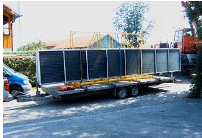
Die Kollektormodule mit einer Länge von 8 Metern wurden jeweils in einem Stück angeliefert.
