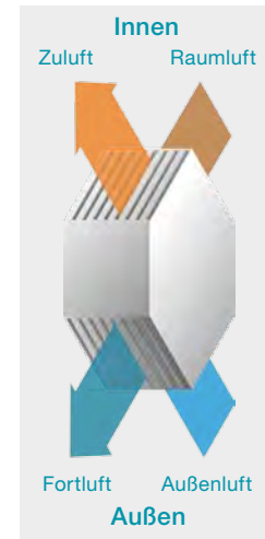
Funktionsweise eines Kreuzgegenstrom-Wärmetauschers
